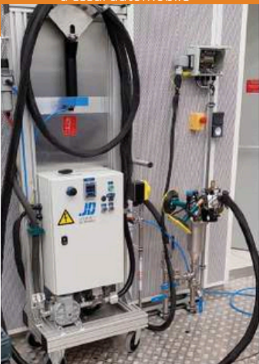
Dispositif de remplissage automatique de réservoir sur banc d'essai automobile
